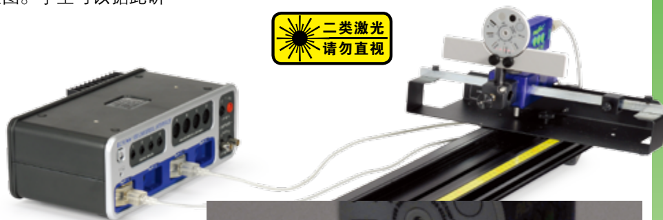
通过安装在线性转换器上的光传感器记录激光干涉图样。
