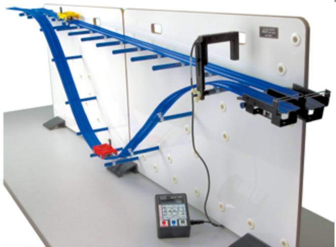
能量守恒原理揭示尽管红车比黄车先抵达终点，但他们的末速度相同
