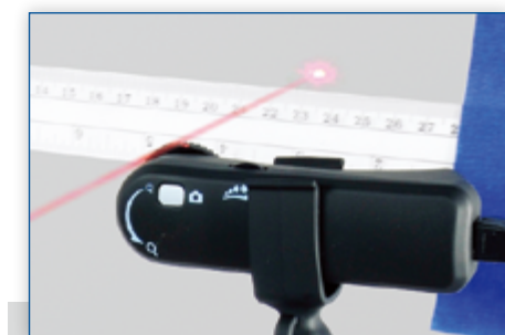
左图，用摄像头记录激光束的震荡。
