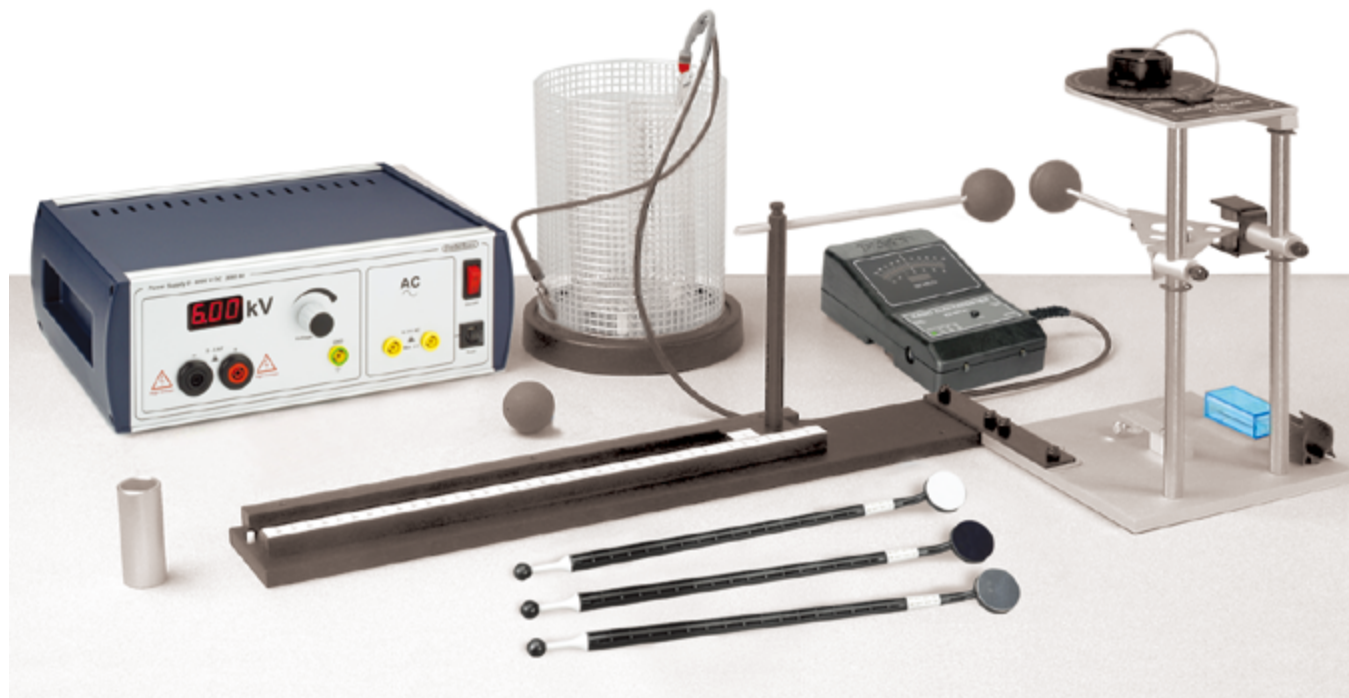
当两球间有静电力时，旋转扭丝，使小球回复到初始的平衡位置，线的扭转量和静电斥力成比例
