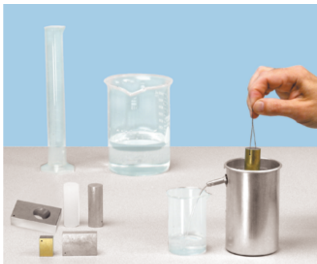
通过测量被排开水的重量来测量浮力。
