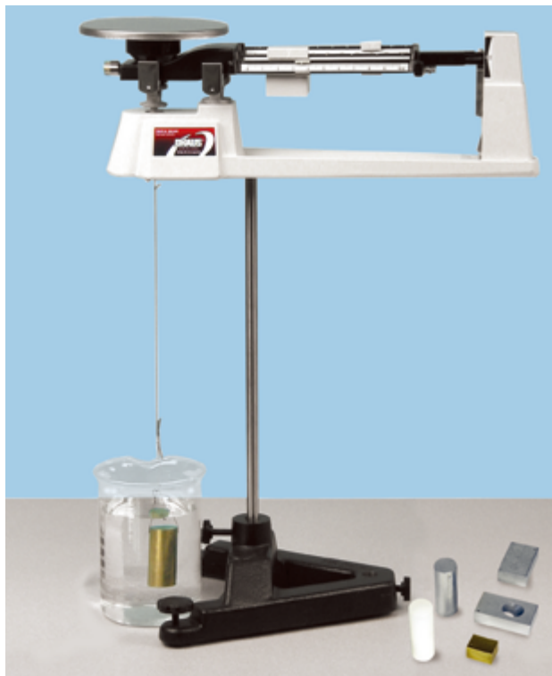
通过测量被排开水的重量来测量浮力。
