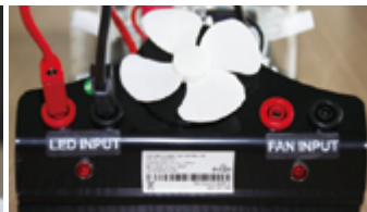
氢燃料电池释放的能量来驱动一个风扇或一对 LED
