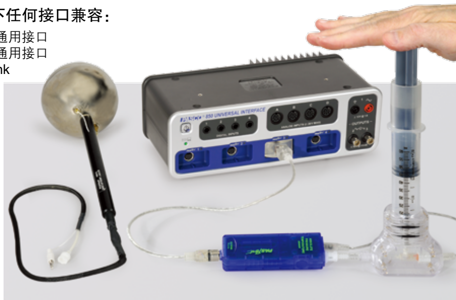
理想气体针管（上图）体积和 T/P 图的斜率等于 nR
