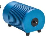
采用风扇制冷,内部带有稳压电路,可以提供稳定的光谱输出。光源输出光谱强度可调,采用SMA905光纤接口,方便通过光纤和其它设备连接,非常适用于可见-近红外的吸收光谱和反射光谱的测量。该光源配有TTL控制的电子快门,非常适合于系统集成。
